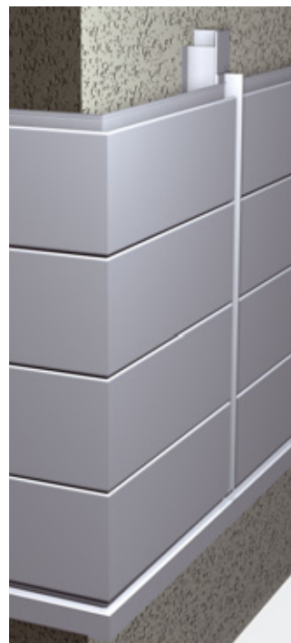
Hoekafwerking van een horizontale bekleding
