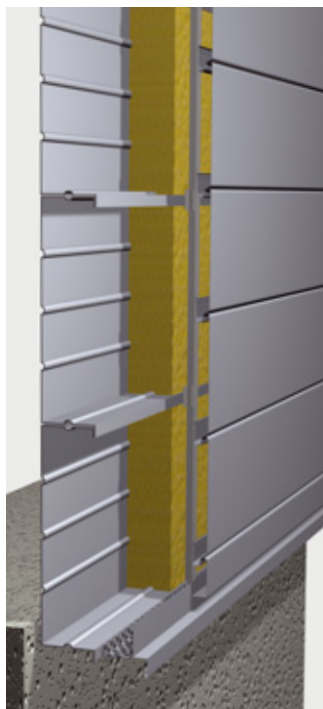
Horizontale bekleding op stalen binnendozen
